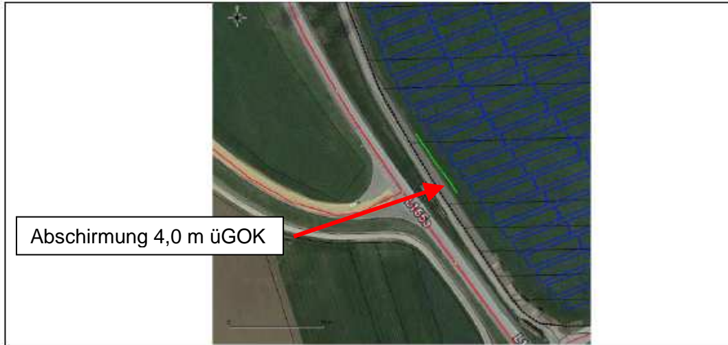
Sichtschutz im Bereich L165a
